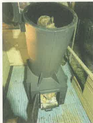
写真2 使用中の薪ストーブ
