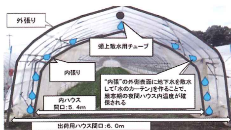
ウォーターカーテンハウスの構造
